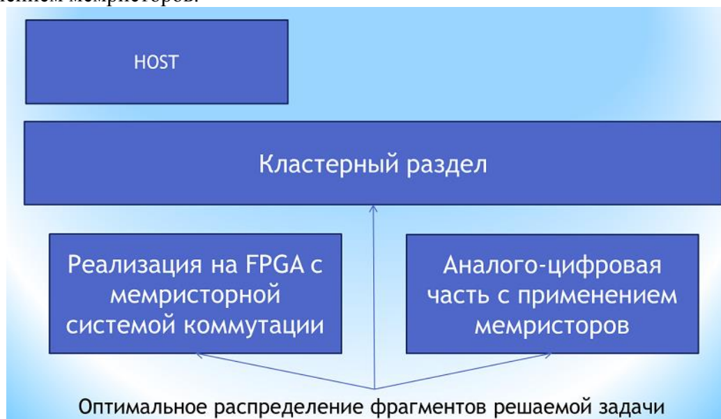
Рис. 30. Архитектура перспективного супернейрокомпьютера с использованием мемристоров
