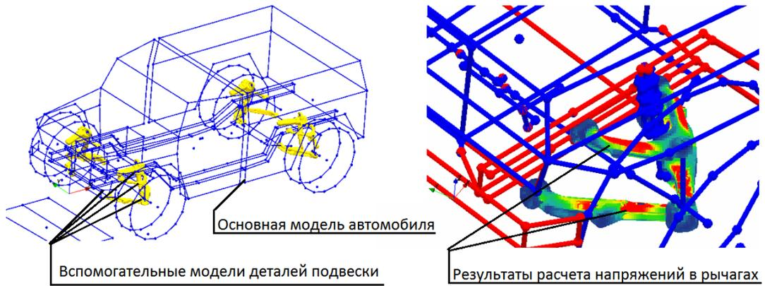
Рис. 1 – Расчетная схема и результаты расчета модели динамики автомобиля в программном комплексе ФРУНД
