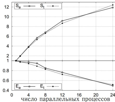
Рис. 2 – Ускорение и эффективность расчета модели динамики автомобиля на кластере
