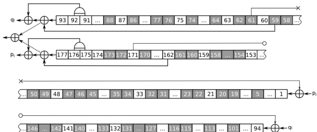
Рис. 1. Декомпозиционное множество, найденное для криптоанализа генератора Bivium.
