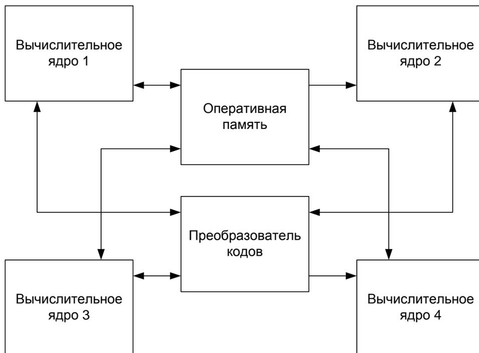
Рисунок 3 - Структурная схема процессора
