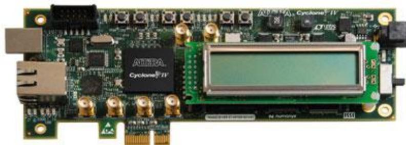
Рисунок 8 – Внешний вид отладочной платы DK-START-4CGX15N
