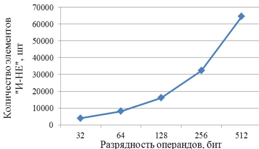
Рисунок 7 – График зависимости аппаратной сложности от разрядности операндов
